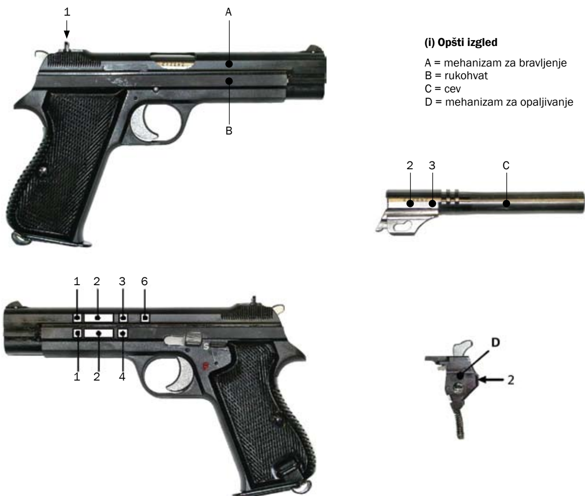
Slika 2. Opšti izgled i pozicija oznaka na pištolju modela 49, kalibra 9mm
